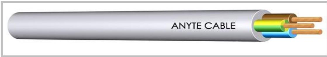
这是一种无卤防火动力电缆，在发生火灾的情况下，它具有增强的防火属性。适合于固定或移动安装。作为供电及连接电缆以满足严格的安全要求，可安装于干燥或潮湿的室内。在具有防紫外线功能和适用的使用温度范围内，可用于露天安装。不能用于直接埋装。它可以作为测量和控制电缆用于加工机械、输送带、机械生产中的生产线、空调系统以及钢铁生产中的生产线。无卤电缆在燃烧时，不会产生有毒致癌气体，特别适用于公共场合，如地铁、机场、轮船、学校、医院等人员密聚和财产贵重的区域。
